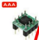
3軸加速度センサーモジュール KXR94-2050
