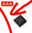
3軸加速度センサー IC XXTC9-2050
